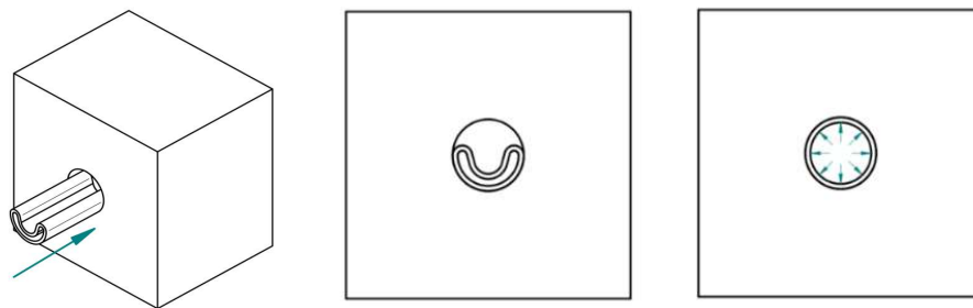
Рис. 6. Установка теплоизоляции в канал трубы.
